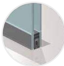
4 Detail 4 Onderzijde deur met valdorpel
