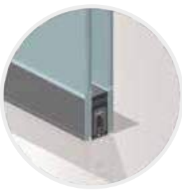
Detail 4 Onderzijde deur met valdorpel
